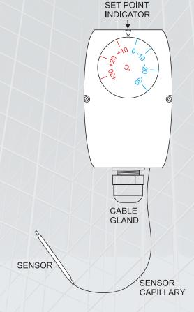
N.B. MAXIMUM VOLTAGE 250VAC MAXIMUM CURRENT 16AMP RESISTIVE
